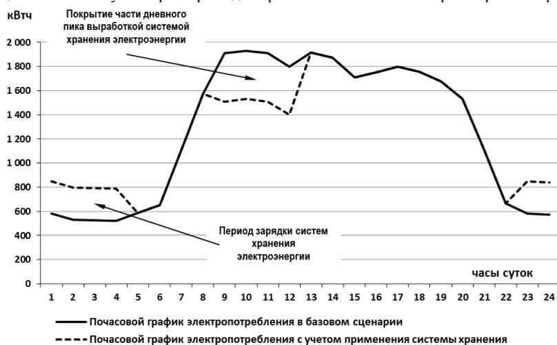
Рис. 4. Почасовые графики электропотребления в базовом варианте и в варианте с учетом применения систем промышленного хранения электроэнергии
